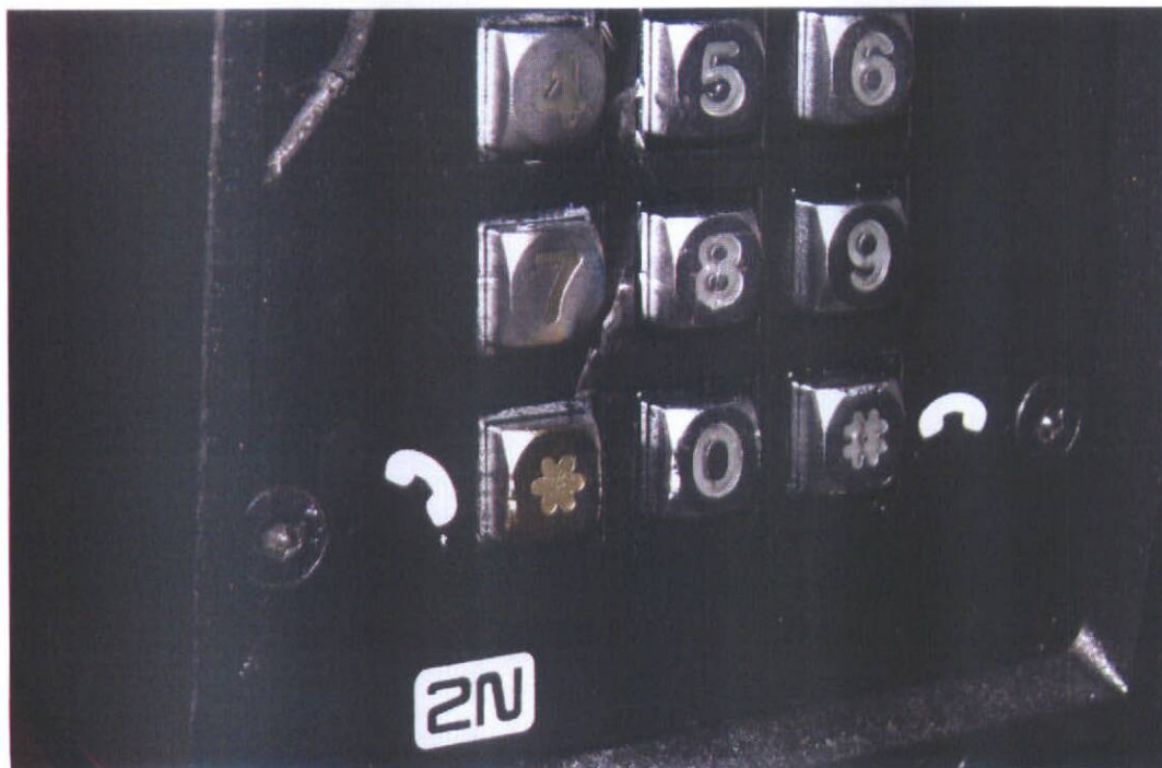
obr. 10 - tlačítko „*“ na numerické klávesnici interkomu 2N® Helios IP Force 9151102CRW po zkoušce 6
