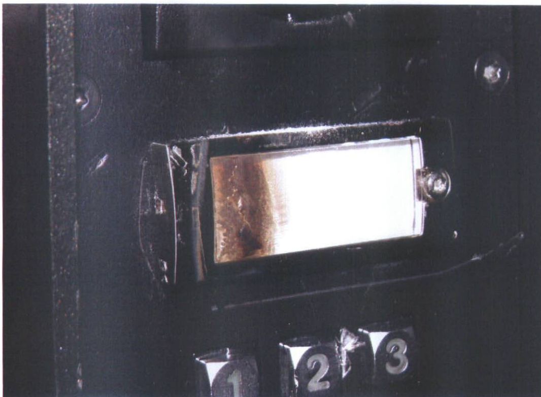
obr. 9 - zvonkové tlačítko interkomu 2N® Helios IP Force 9151102CRW po zkoušce 6
