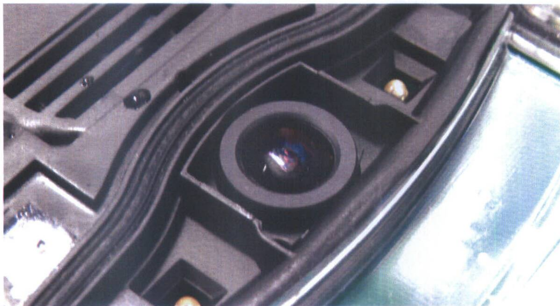
obr. 22 - nepoškozená kamera interkomu 2N® Helios IP Verso 9155101C
