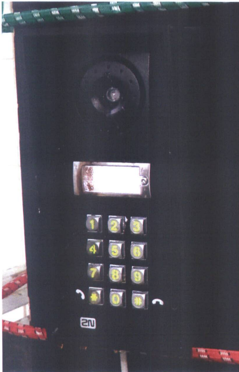
obr. 11 - funkční podsvit všech tlačítek interkomu 2N® Helios IP Force 9151102CRW po zkoušení
