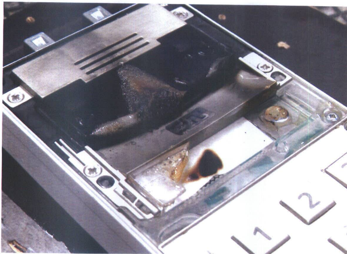
obr. 20 - interkom 2N® Helios IP Verso 9155101C po zkoušení
