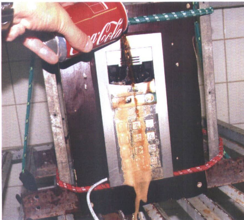
obr. 18 - zkouška 7 interkomu 2N® Helios IP Verso 9155101C
