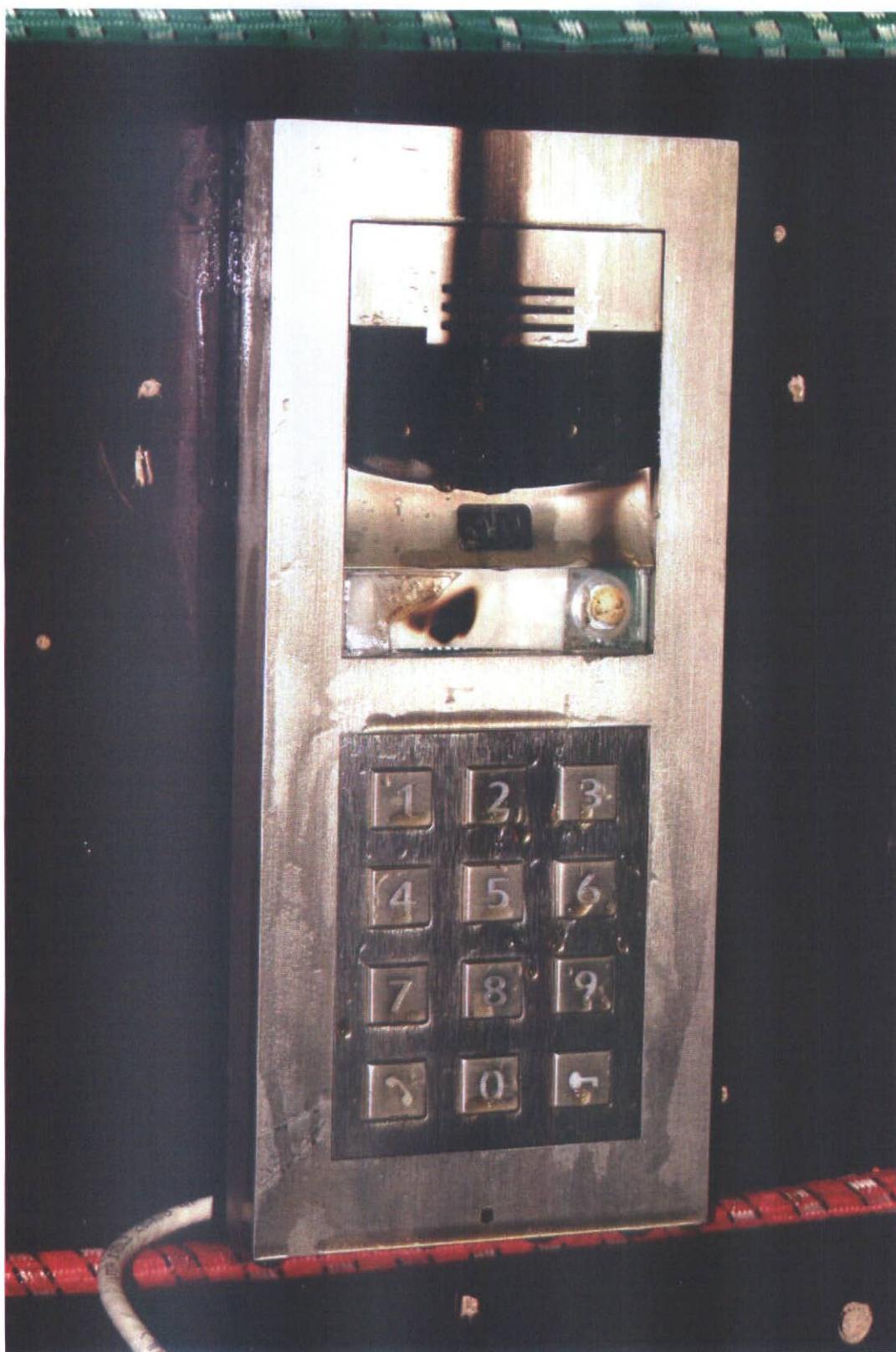
obr. 19 - interkom 2N® Helios IP Verso 9155101C po zkoušení
