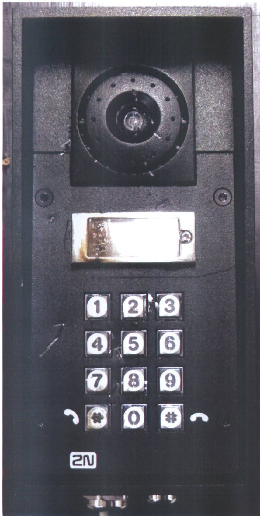
obr. 12 - interkom 2N® Helios IP Force 9151102CRW po zkoušení
