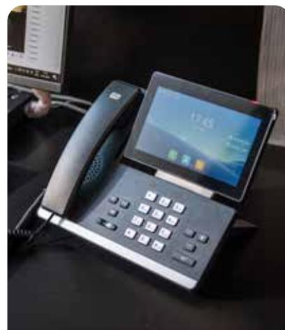
Nonstop recepce využívají **2N® IP Phone D7A**, na kterém přijímají hovory ze vstupních interkomů. Na 7" dotykovém displeji vidí náhledu z kamery interkomů a otevírají dveře jediným stisknutím tlačítka.
