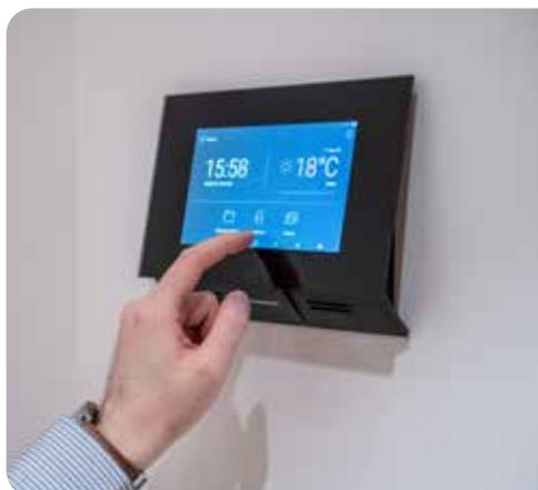
Systém dále zahrnuje 57 odpovídacích jednotek **2N® Indoor Touch 2.0**, které byly nainstalovány do všech bytů. Tento stylový vnitřní komunikátor disponuje odolným 7" HD dotykovým displejem z tvrzeného skla a možností integrace se systémy domácí automatizace.
