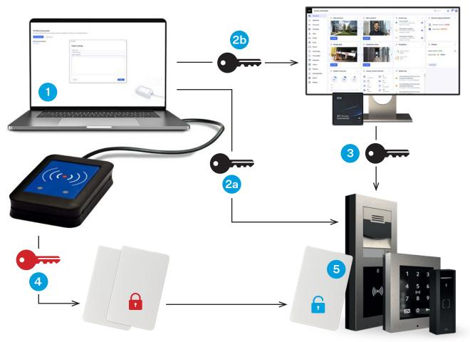
Au cœur de toute la solution se trouve **2N® PlCard Commander** – une application logicielle qui permet aux administrateurs de créer un jeu de clés cryptographiques unique pour chaque site **1**. Les clés sont basées sur la **clé de chiffrement principale (MEK)**: à partir de laquelle les clés de chiffrement pour l'encodage des informations d'identification et des clés de lecture sont dérivées.
