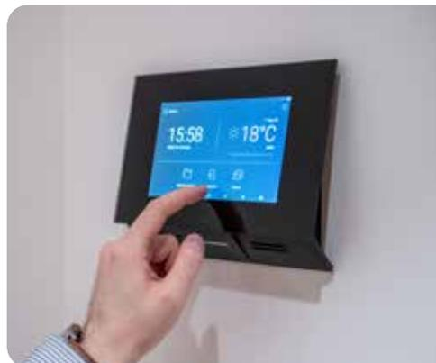
Il sistema include inoltre 57 unità di risposta **2N® Indoor Touch 2.0**, che sono state installate in tutti gli appartamenti. Questo elegante comunicatore interno dispone di un robusto display touchscreen in HD 7" in vetro temprato e possibilità di integrazione con i sistemi della domotica.
